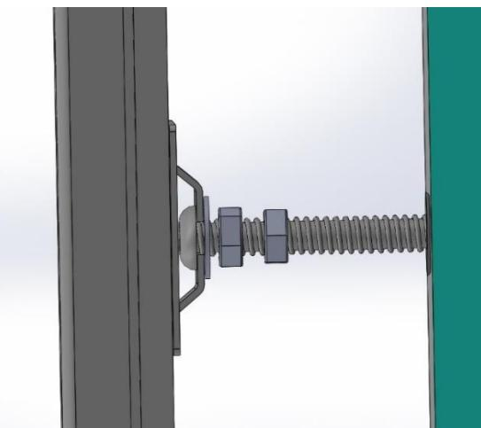
Схема крепления коробки на монтажные планки
