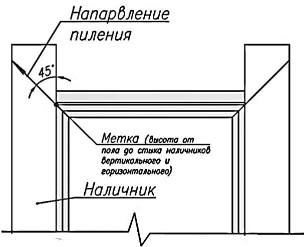
При помощи угломера отмерить от сделанной отметки угол ровно в 45 градусов и отметить карандашом. Лишнее отрезать и наличник временно отложить в сторону.
